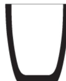
\*La capacità utile di lavoro dei crogioli è calcolata al 90% della capacità totale riferita alla fusione di ottone con peso specifico 8.35 g/cm<sup>3</sup>
